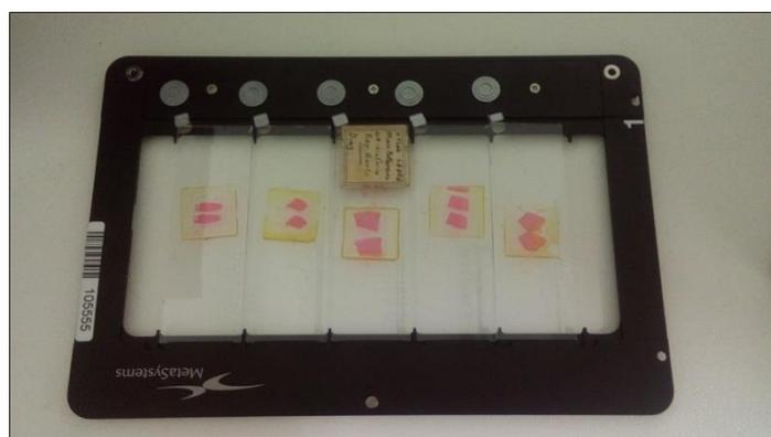
Bandeja de lâminas do Sistema VSlide com cinco lâminas da Coleção de Febre Amarela. O sistema adquirido possui 80 bandejas (capacidade máxima de 400 lâminas).
