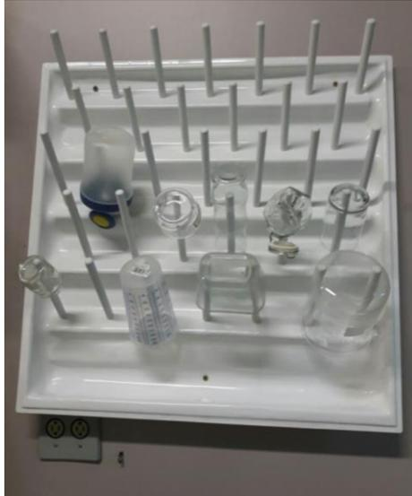
Utilizado para secar os utensílios do laboratório.
