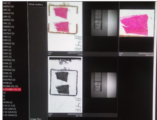
Imagens de calibração (tons de cinza) e finais (coloridas) de lâmina histológica de caso da Coleção de Febre Amarela gerada com o Sistema VSlide e disposta no banco de dados integrado ao software do equipamento.
