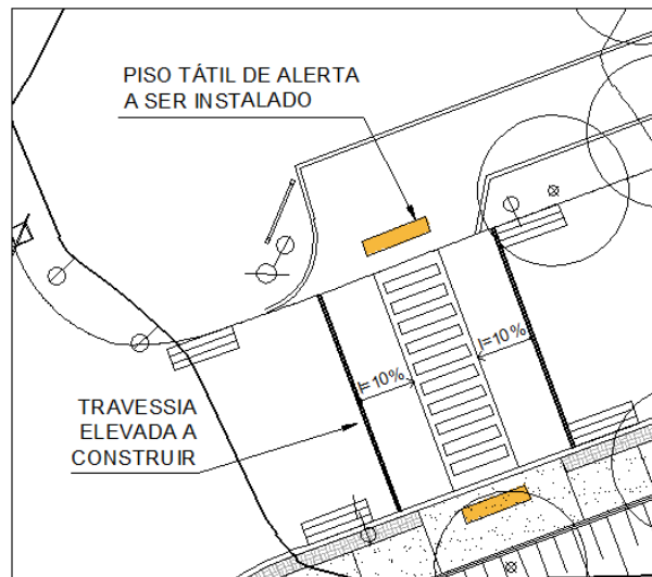
Figura 9 - Criação de travessia elevada para pedestres – Fiocruz, 2014
